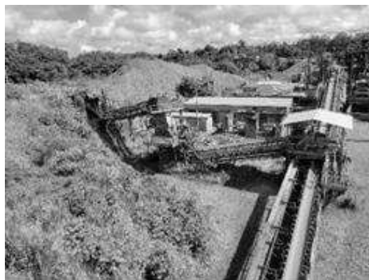
Figura 10 - Transportador de correia inclinado, dimensão 48" x 67m
