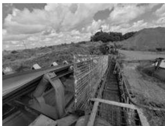
Figura 6 - Transportador de correia inclinado, dimensão 48" x 204,5m
