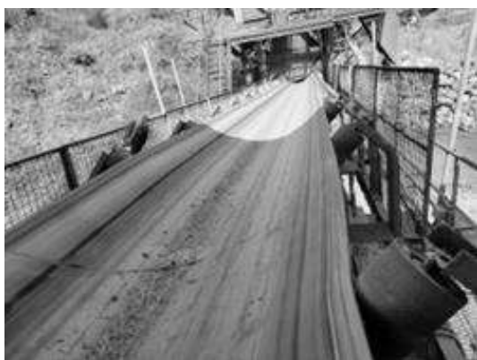
Figura 8 - Transportador de correia inclinado, dimensão 48" x 120m
